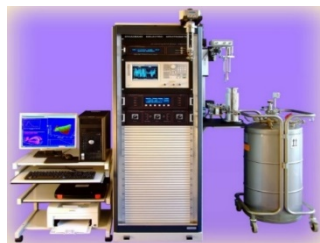
Комплекс диэлектрического анализа Concept 50 Novocontrol
