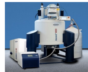
ЯМР-спектрометр Bruker AVANCE III 400 МГц
