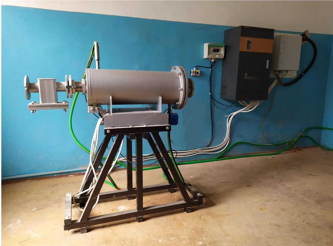
Аппарат вихревого слоя обеспечивает полное уничтожение микроорганизмов и яиц гельминтов
